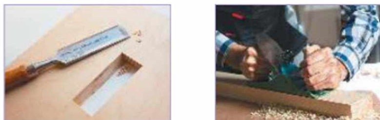
Рис. 5.11. Выполнение отверстия долотом
