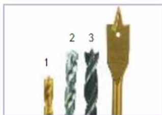
Рис. 5.10. Патрон для крепления свёрл (а); образцы свёрл (б); наиболее распространённые виды свёрл (в): 1 — спиральное; 2 — витое; 3 — перьевое
