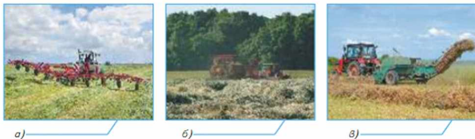
Рис. 11.7. Несколько этапов механизированной заготовки прессованного сена: а — ворошение скошенной травы ротационными граблями; б, в — подбор валков и прессование в тюки или рулоны пресс-подборщиками
