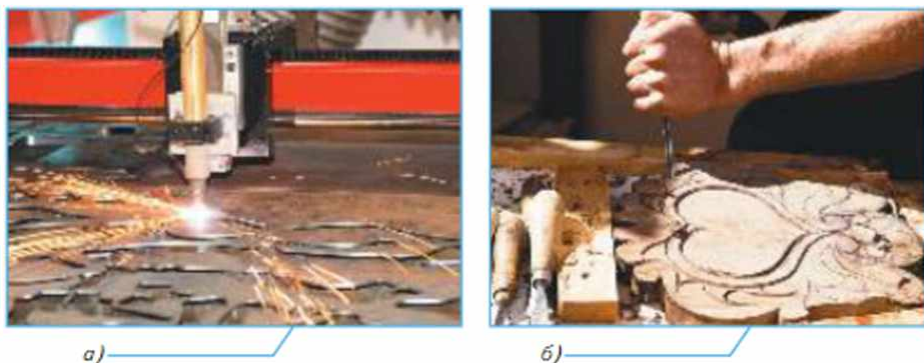
Рис. 3.2. Резание: а — лазером; б — механическими инструментами
