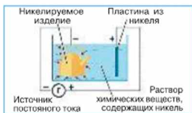
Рис. 5.20. Схема установки для никелирования посуды
