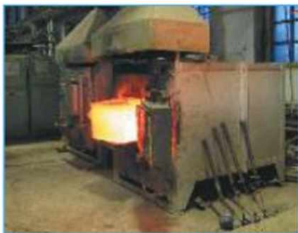
Рис. 5.2. Индукционная тигельная печь (а); муфельная печь (б)
