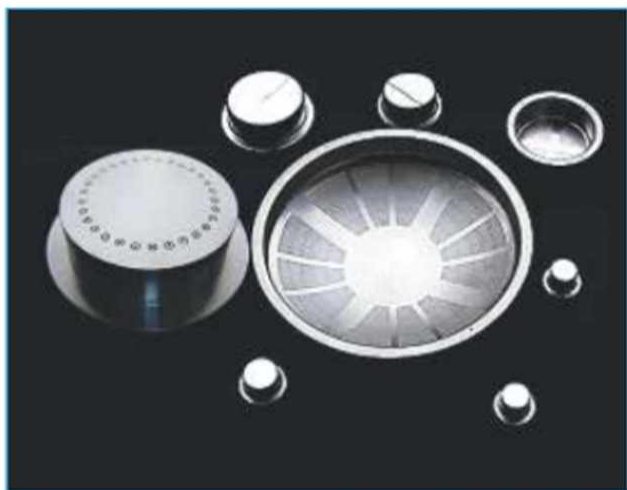
Рис. 5.7. Фильтры для формования волокон различной толщины из раствора
