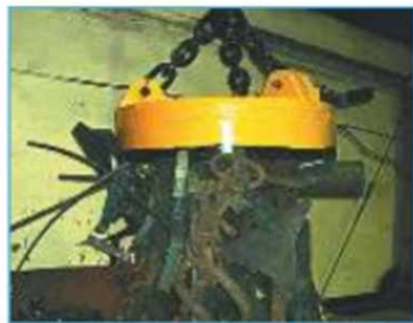
Рис. 8.1. Применение энергии магнитного поля: а — электромагнитный кран; б — сепаратор
