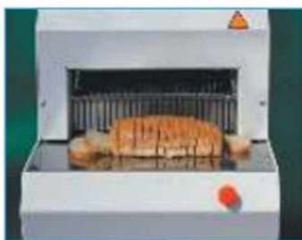
Рис. 2.19. Полупромышленная технологическая машина для нарезания хлеба на ломти
