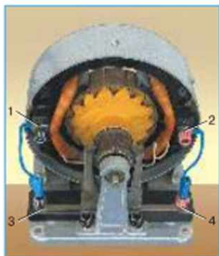
Рис. 8.8. Электрогенератор: 1, 2 — концы обмоток электромагнита; 3, 4 — выходные клеммы
