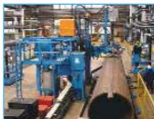
Рис. 2.23. Подача стального листа на формование (а); проверка качества сварки (б)
